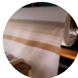
**3** Das Vorgewebe mit detaillierter Musterinformation wird gefertigt
